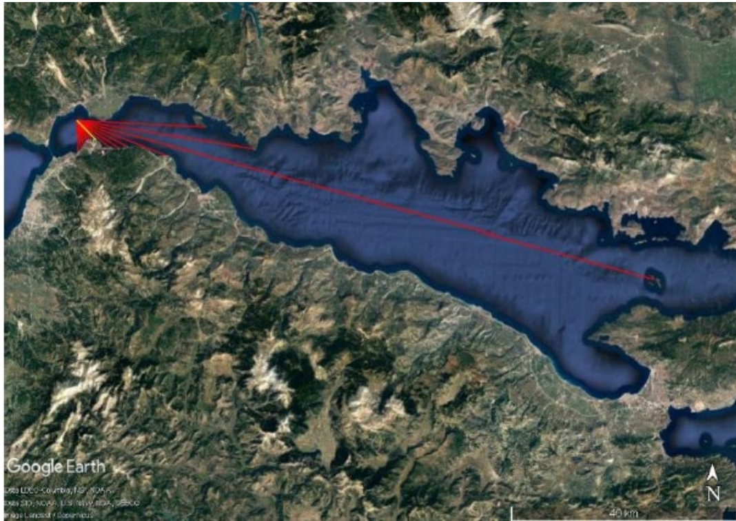
Εικόνα 4-3: Ακτίνες ενεργού αναπτύγματος πελάγους για την Νοτιοανατολική Διεύθυνση (Πηγή Υποβάθρου: Google Earth)
