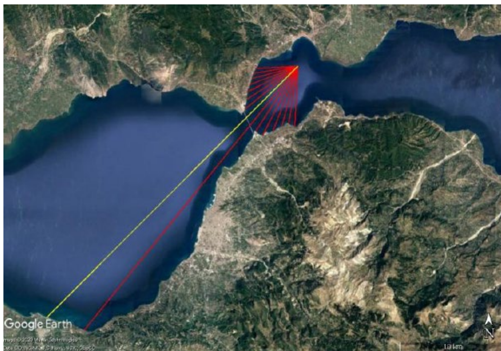
Εικόνα 4-5: Ακτίνες ενεργού αναπτύγματος πελάγους για την Νοτιοδυτική Διεύθυνση (Πηγή Υποβάθρου: Google Earth)
