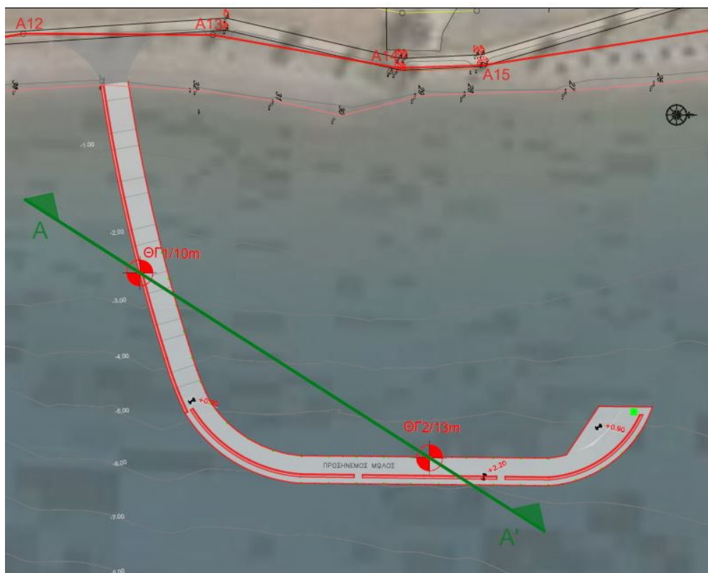
Εικόνα 5-3: Θέσεις εκτελεσθεισών γεωτρήσεων, Γεωτεχνική Έρευνα (2023)
